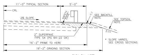
BACK FILL NOTE: SHOULDERS SHALL BE BACK FILLED AND COMPACTED AS PART OF THE FINISHING OPERATION, PRICE TO BE INCLUDED IN EARTHWORK.
